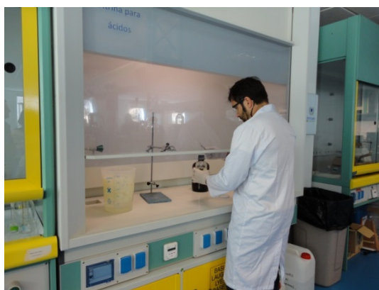
Figura 3. Vitrina para extracción de gases o vapores contaminantes
